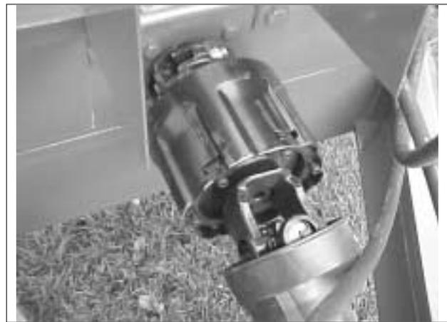
**FIGURE 4. PTO SHIELD FLIPPED UP**
