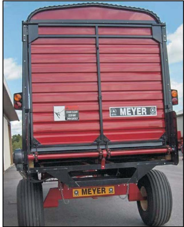
**FIGURE 4. REAR OPENING DISCHARGE DOOR**
